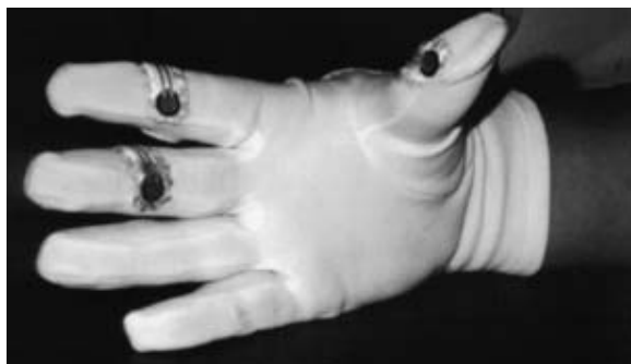
Figura 04. Luva com sensores no dedo polegar e nas falanges médias do dedo médio e indicador e (Fonte: Castro; Cliquet, 2000, p. 2).
