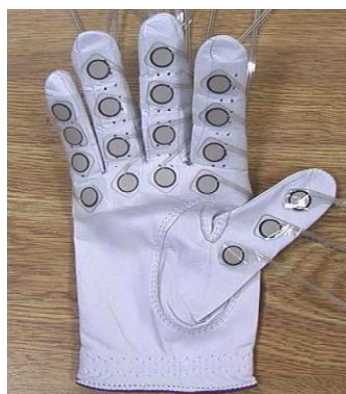
Figura 05. Sensores FlexiForce™ fixados em uma luva para avaliar modelos de pipetas. (Fonte: LU et al. , 2008, p. 20).
