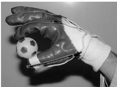
Figura 02. Luva equipada com sensores de posição e força (Fonte: Tarchanidis e Lygouras, 2003, p. 1)
