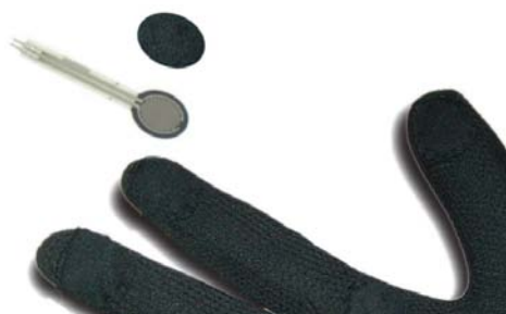
Figura 09. Esquema de alojamento dos sensores, vista explodida.
