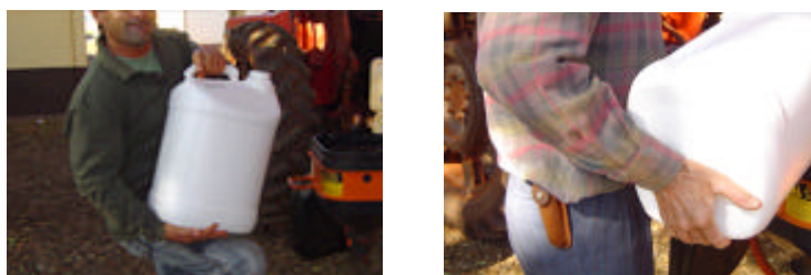
Figura 3 - Ausência de pega inferior na embalagem Retangular
