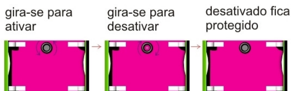
Figura 03: sistema de giro do mini-projetor
