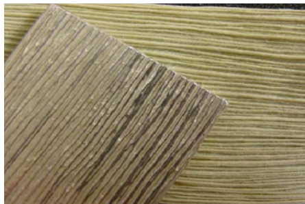
Figura 4: Placa de metal com textura da palha de milho, obtida através do scanner 3D e transposta através da prototipagem com auxílio da fresa CNC. Fonte: http://www.ndsm.ufrgs.br/
