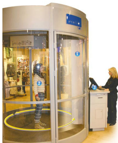
Fig 2: Cabine desenvolvida pela Intellifit que funciona como body scanner 3D. Fonte: Revista Veja, 25 de Maio de 2005, p.70.
