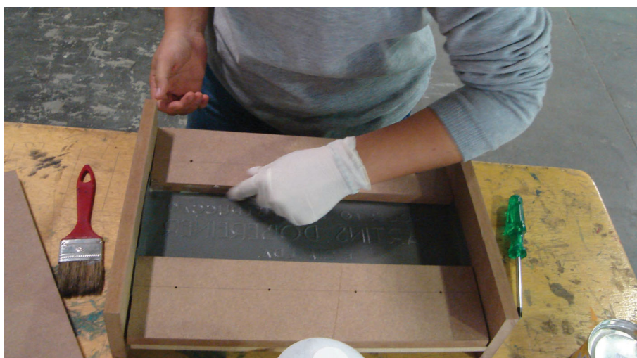
Fig.7 Molde de silicone fixado numa forma de MDF (Foto: Flávio Cescato)
