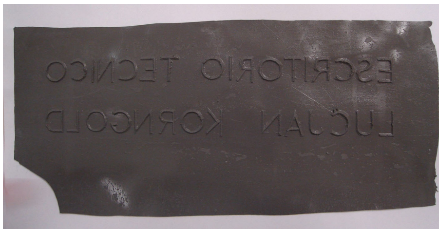
Fig.02 Molde negativo em silicone 5022 (Foto: Fernanda Indicatti)
