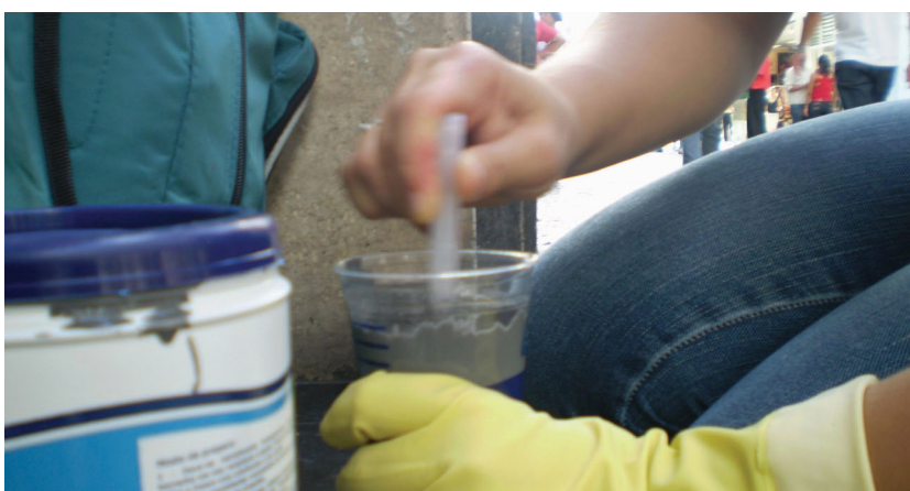
Fig.4 A bolsista prepara a mistura de silicone com 10% de catalisador. (Foto: Flávio Cescato)
