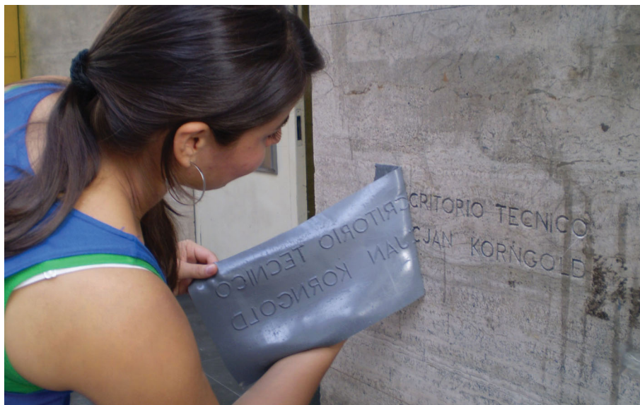
Fig.6. Por fim a bolsista extrai do molde de silicone. Epígrafe do Edifício Direita. (Foto: Flávio Cescato)
