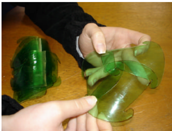
Figura 5 – Módulos da luminária sendo encaixados
