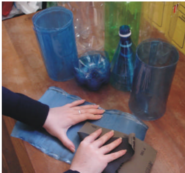
Figura 2 - Garrafa descartada sendo lixada
