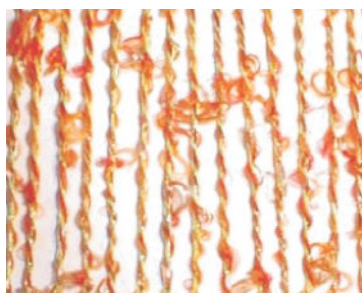
Fig. 8 – Mistura de filamentos de SMP a fios tradicionais, fios fantasia.
